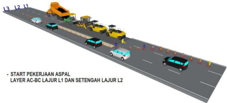
**Gambar 3. 15 Salah Satu Gambar Perencanaan Proses Penghamparan AC-BC menggunakan Alat Asphalt Finisher**
