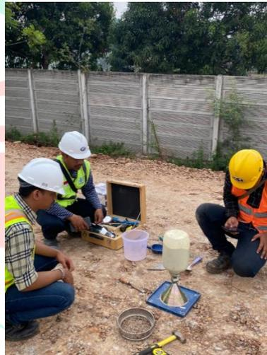
**Gambar 3. 37** Pekerjaan *Sand Cone Test*
