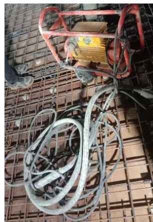
Gambar 3. 20 Vibrator (Sumber; Dokumentasi Pribadi, 2024)
