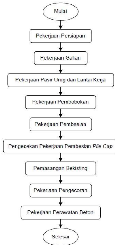
Gambar 3. 47 Diagram Alir Pekerjaan Pile Cap
