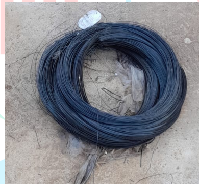
Gambar 3. 15 Kawat Bendrat (Sumber : Dokumentasi Pribadi)
