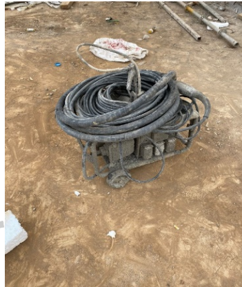
Gambar 3. 30 Vibrator (Sumber : Dokumentasi Pribadi)
