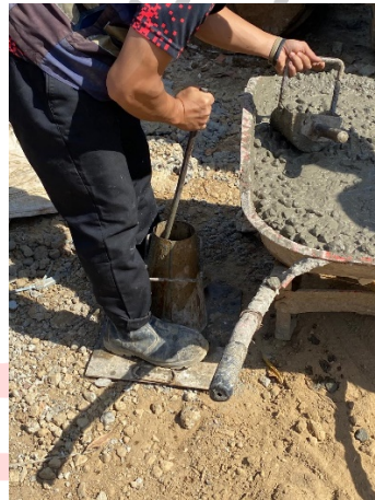
Gambar 3. 50 Pengujian Slump Test (Sumber : Dokumentasi Pribadi)
