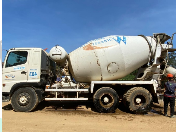
Gambar 3. 49 Proses Pencampuran dan Pengadukan Beton Dalam Truck Mixer (Sumber : Dokumentasi Pribadi)
