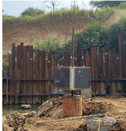
Gambar 3. 54 Proses Pengujian PDA (Sumber : Dokumentasi Pribadi)
