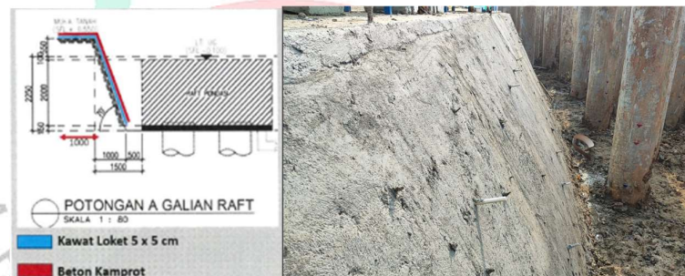
Gambar 3. 30 Detail proteksi Lereng dan Tampaknya di Lapangan
