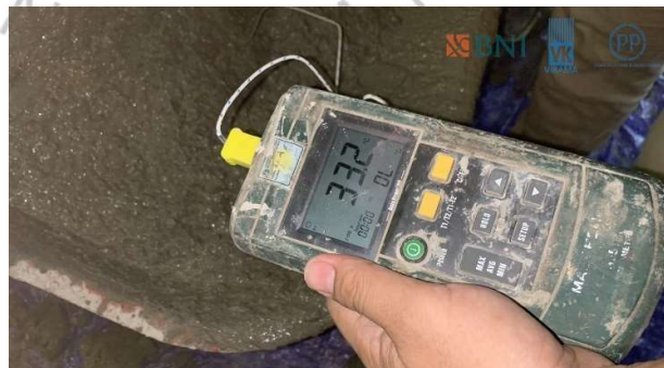
Gambar 3. 48 Pengecekan Suhu Pada Sampel Beton (Sumber: Dokumentasi Pribadi, 2024)
