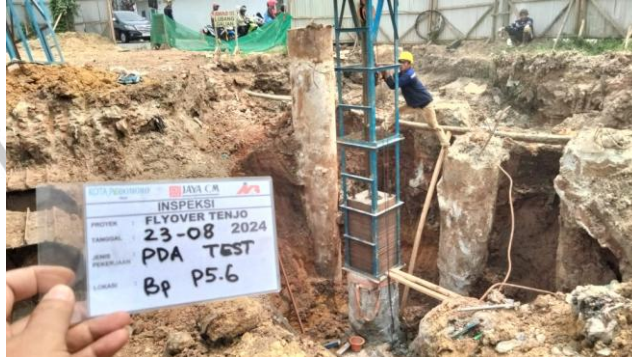
Gambar 3.25 Proses Pengujian PDA Test pada P5
