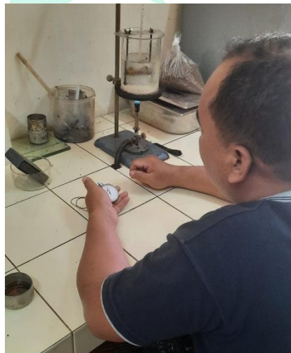
Lampiran 1. 3 Perhitungan Waktu Uji Penetrasi Menggunakan Stopwatch
