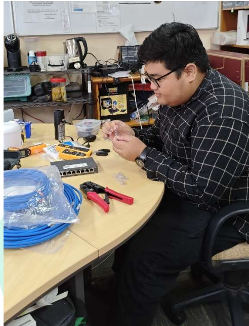
Gambar 3.21 Praktikan mengurutkan warna kabel.
