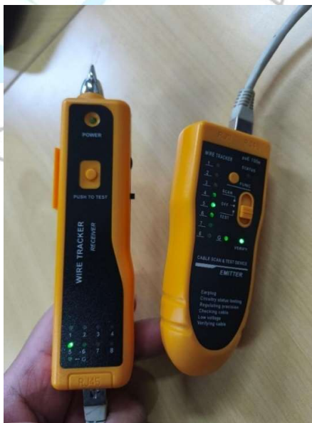
Gambar 3.23 Praktikan melakukan tes kabel LAN
