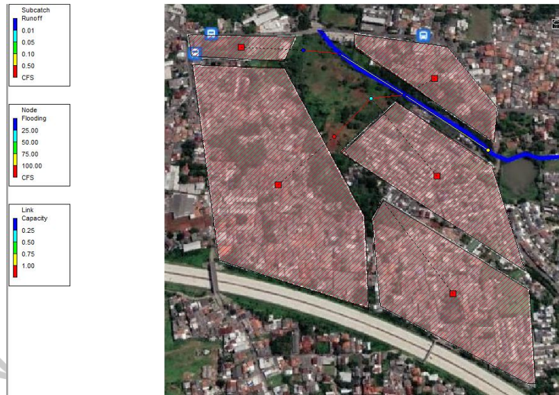
Gambar 4. 9 Hasil Dari Pemodelan Model Jaringan Drainase Eksisting
