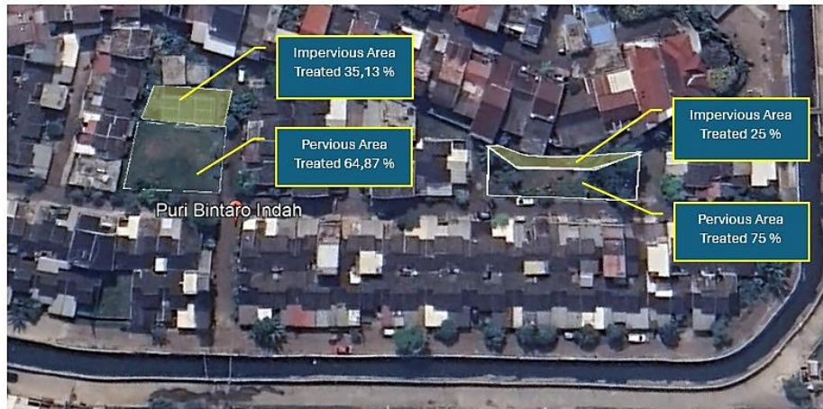
Gambar 4.16 Area impervious dan pervious area sumur resapan 1 dan 2
