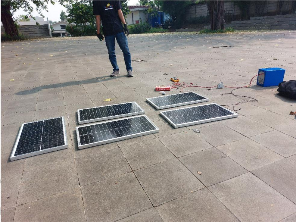
**Gambar 3. 24 Foto Charging Baterai dengan Solar Panel (1)**
