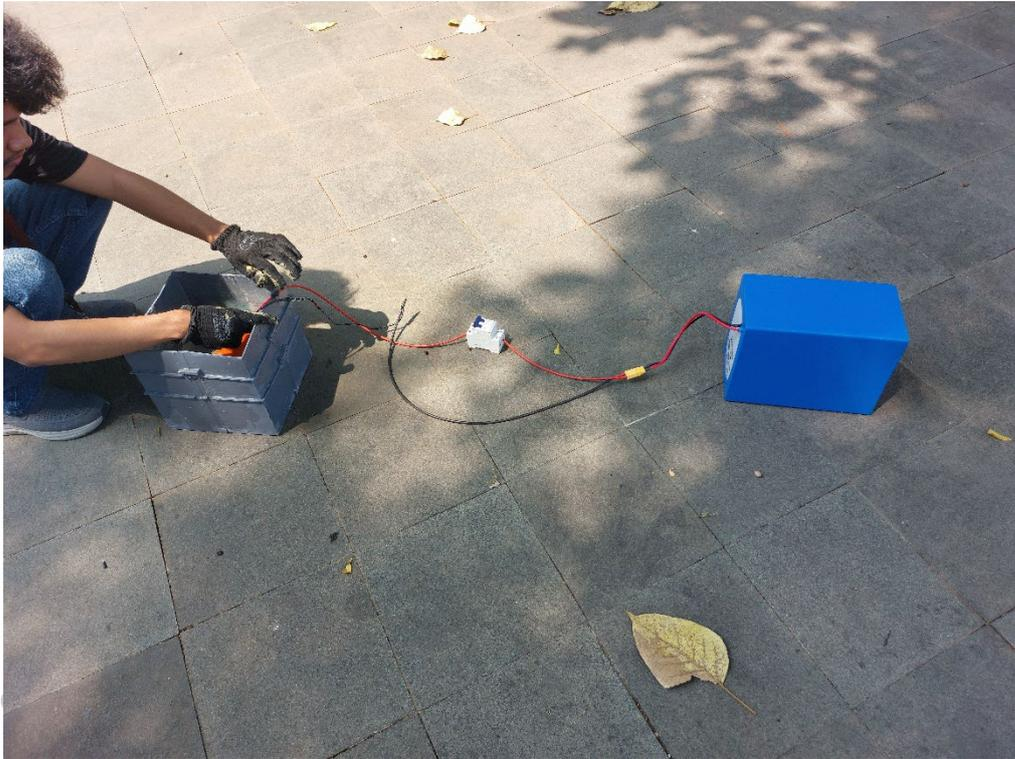
Gambar 3. 23 Discharging dengan Metode Elektrolisis (4)
