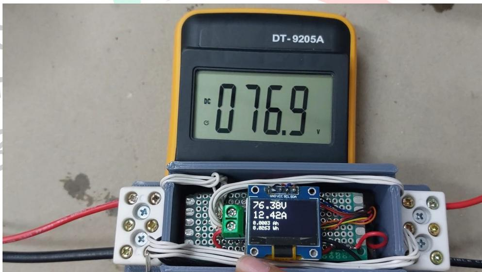
Gambar 3. 19 Pengujian Tegangan Energy Meter
