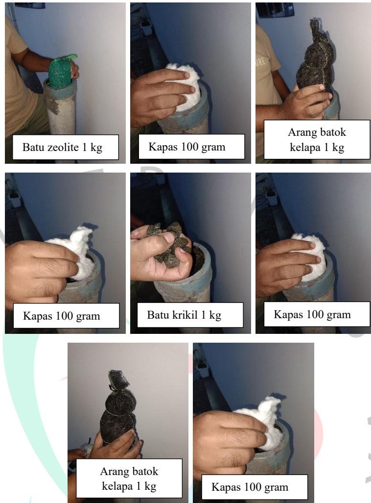
Gambar 4.17 Proses memasukkan bahan-bahan filtrasi ke dalam Portable Water Treatment (Dokumentasi Pribadi, 2024)
