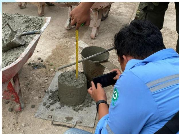
**Gambar 3. 49 Proses Pengujian slump Beton**
