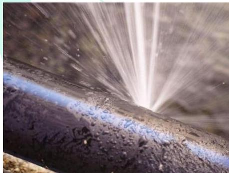
**Gambar 3. 50 Kebocoran Pipa HDPE**
