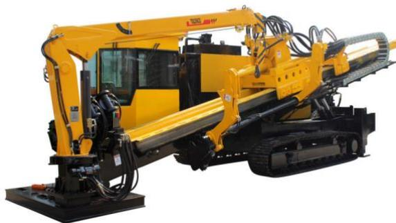
**Gambar 3. 25 Mesin HDD**
