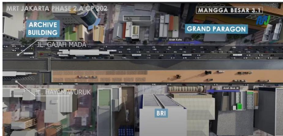
**Gambar 3. 13 Ilustrasi Pengalihan Jalan Detour**
