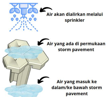
Gambar 3. 3 Skema Pengujian Storm Pavement Sumber: Dokumen Peneliti, 2025
