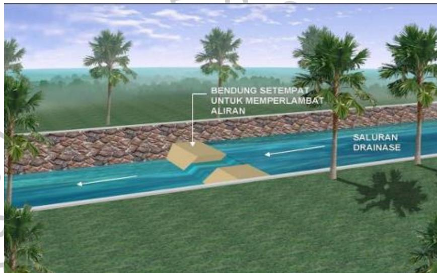
Gambar 2. 10 Kolam Retensi di Dalam Badan Sungai (Kementerian PUPR, 2020)
