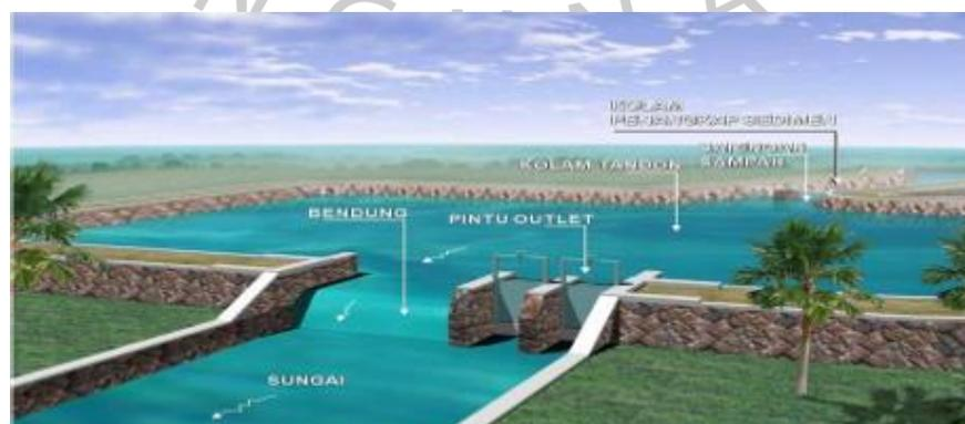
Gambar 2. 9 Kolam Retensi Tipe di Dalam Badan Sungai (Kementerian PUPR, 2020)
