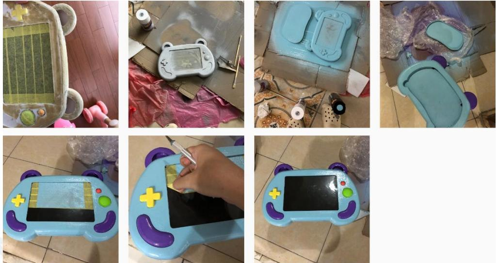
*Gambar 18 Proses Produksi Prototype (Sumber: Peneliti)*
