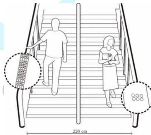
Gambar 2.17 Huruf braille di sisi atas pegangan rambatan untuk menunjukkan posisi anak tangga
