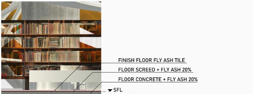
Gambar 4.6 Penerapan Fly Ash Pada Bangunan
