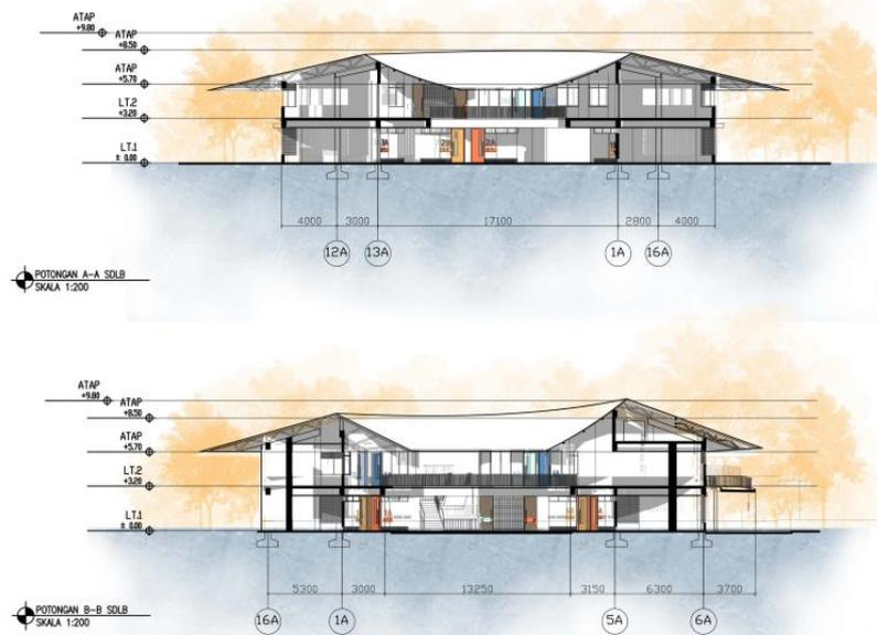
**Gambar 5. 22 Potongan Bangunan SDLB**
