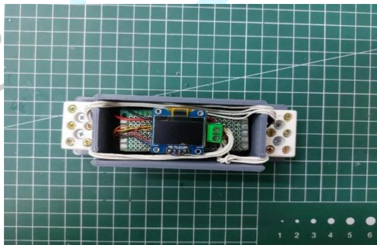
Gambar 4.15. Foto Energy Meter dengan Casing 3D Print
