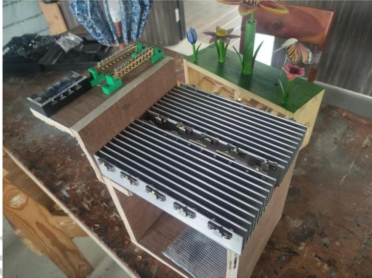
Gambar 5.2. Foto *Dummy Load* yang Digunakan pada Saat Pengujian (1)
