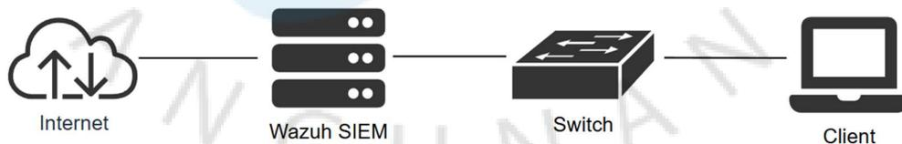
Gambar 3.4 Topologi Jaringan Pengujian
