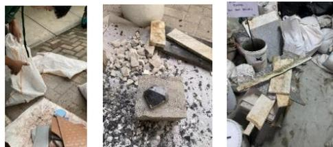
**Gambar 3. 2** Proses Penyiapan Material Pengganti Agregat Kasar Alami
