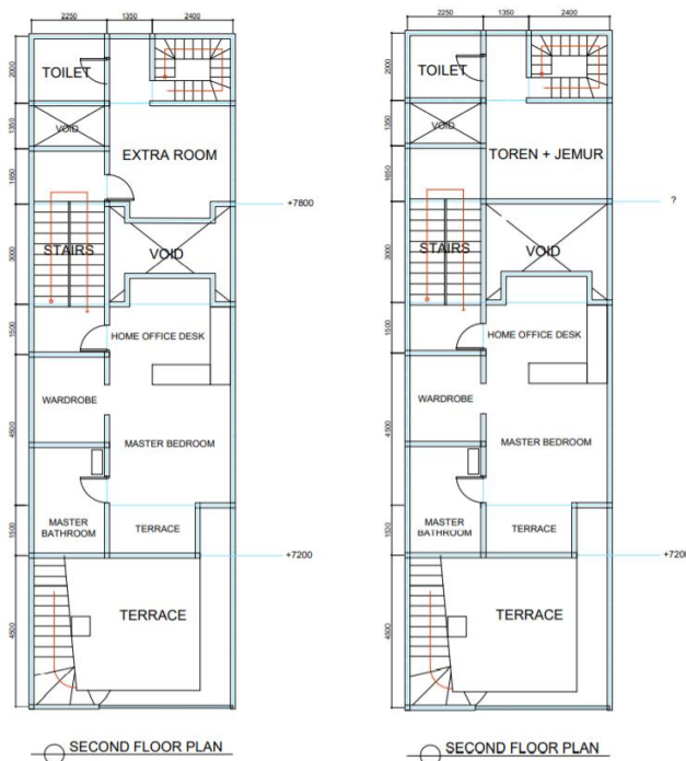
Gambar 3. 8a dan 3.8b Denah Lantai 2a dan 2b Proyek ALE-V18 Sumber: Data Proyek MjBarchitects
