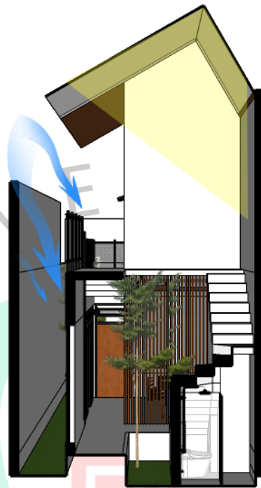
Gambar 3.13. Skema Sirkulasi Udara dan Cahaya Matahari Sumber: Dokumentasi Pribadi 2021
