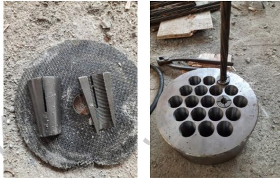
**Gambar 3.33 Simulasi Pemasangan Wedges pada Strand**
