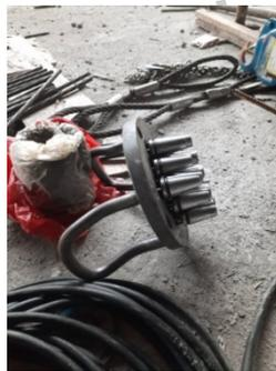
**Gambar 3.34 *Ground Wedges* dan *Gripper Plate***
