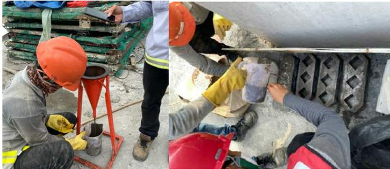
**Gambar 3.55 Uji Viskositas dan Persiapan Benda Uji *Grouting Mix***
