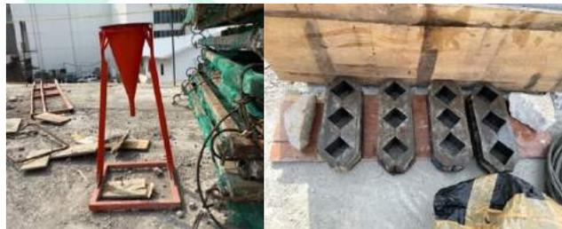
**Gambar 3.21 Flow Cone dan Cetakan Mortar Cement**
