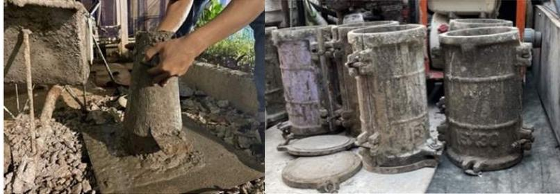
Gambar 3.13 Kerucut Abrams dan Alat Cetak Benda Uji Beton (Silinder)
