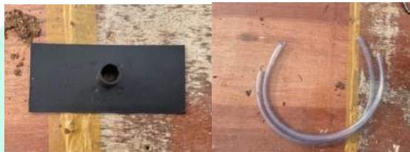
Gambar 3.36 Kapler dan Grouting Vent
