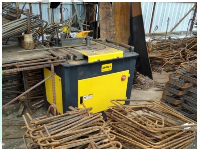
Gambar 0.12 Bar Bender di Proyek
