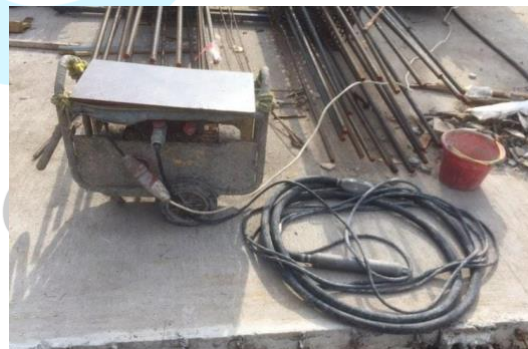
Gambar 0.19 Concrete Vibrator Digunakan di Proyek
