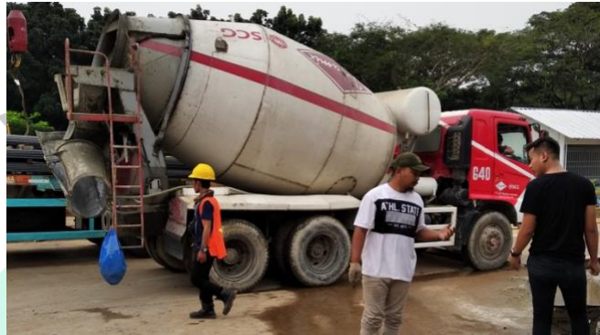
Gambar 0.14 Truck Mixer Menunggu Untuk Uji Slump
