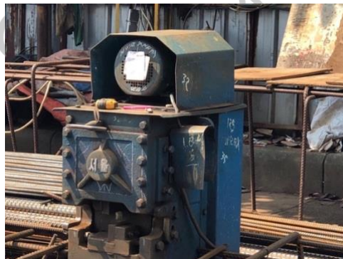
Gambar 0.11 Bar Cutter yang beroperasi di Proyek
