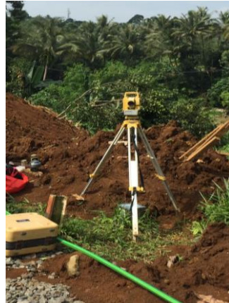
Gambar 3.15 Posisi Total Station di Atas Titik Bench Mark (Sumber : Data Pribadi)
