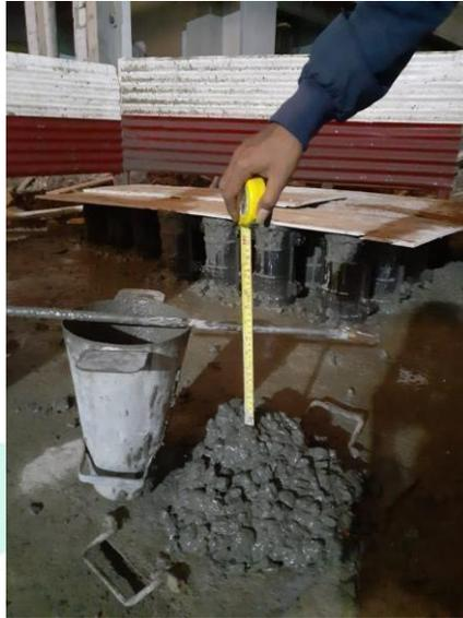
Gambar 3. 103 Tes Uji Slump
