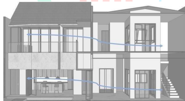
Gambar 4.3.2 Konsep wind driven ventilation pada DAK House
