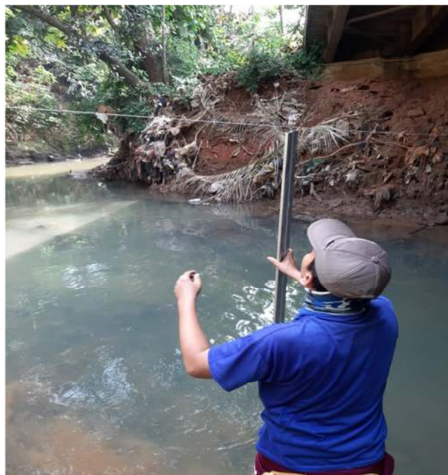
Gambar.L.3.4 Pengukuran Kedalaman dari Dasar Penampang (Dokumen Pribadi, 2020)
