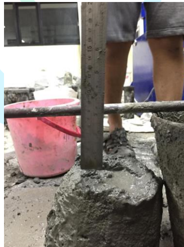
Gambar 4.4 Pengujian Slump pada Benda Uji Beton AS 40
