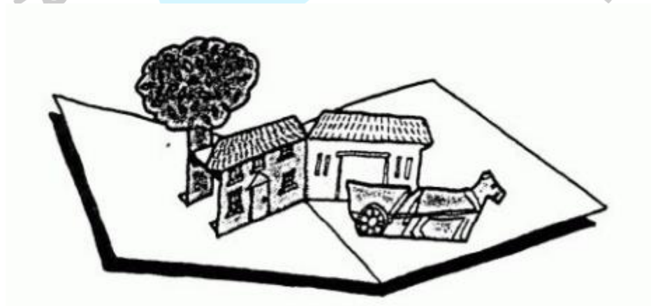
Gambar 2.4 Bentuk Lipatan Kombinasi Lipatan V Fold dan Parallelogram (Sumber : Buku Pop-Up a Manual of Paper Mechanisms karya Duncan Birmingham)
