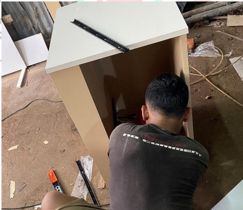
Gambar 4.65 Pemasangan rel laci
