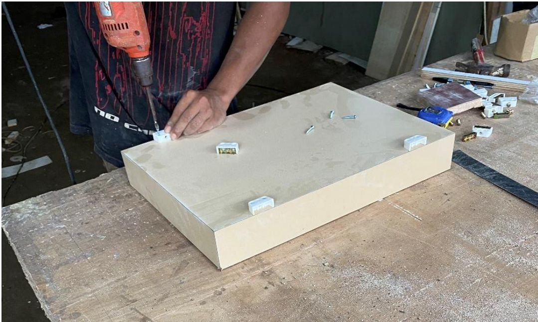
Gambar 4.64 Pemasangan traves siku
