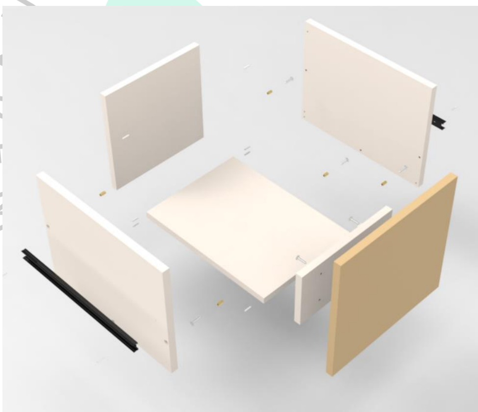
Gambar 4.36 Render exploded view pada bagian laci besar
