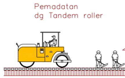
Gambar 4.18 Ilustrasi Pelaksanaan Pemasatan dengan Tandem Roller
