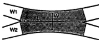
Gambar 2.9 Ilustrasi untuk Parameter Geometrik (Sumber: MKJI 1997)
