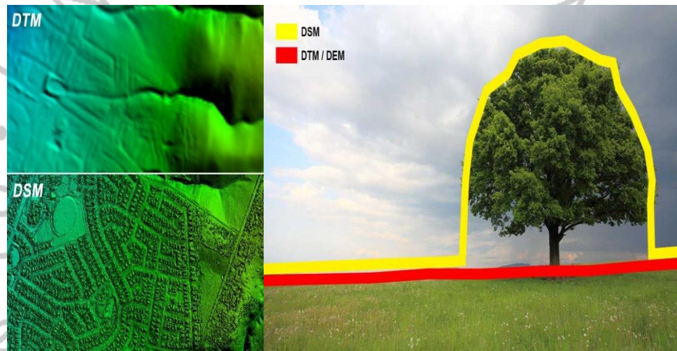
Gambar 2.4 Perbedaan DEM, DSM, DTM (Zona Spasial, 2018)
