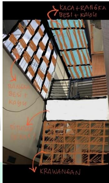
**Gambar 3. 8 Desain skematik bagian dinding dan langit-langit dengan Sketsa**
