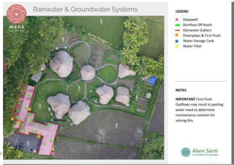
Gambar 3. 5 Posisi peletakkan komponen-komponen dari sistem Rainwater Harvesting Sumber : Arsip Mana Earthly Paradise dan Alam Santi
