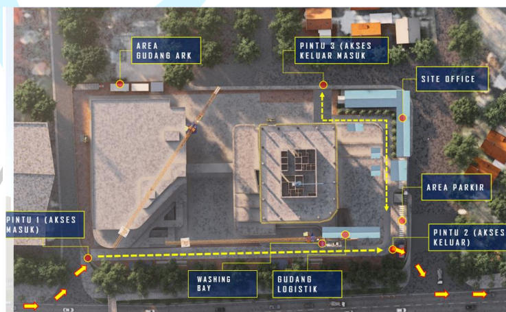
Gambar 3.64 Alur dan area pelaksanaan pengerjaan pengecoran raft foundation (Dokumen proyek KSO PT PP (Persero) Tbk – PT Arkonin, 2022)
