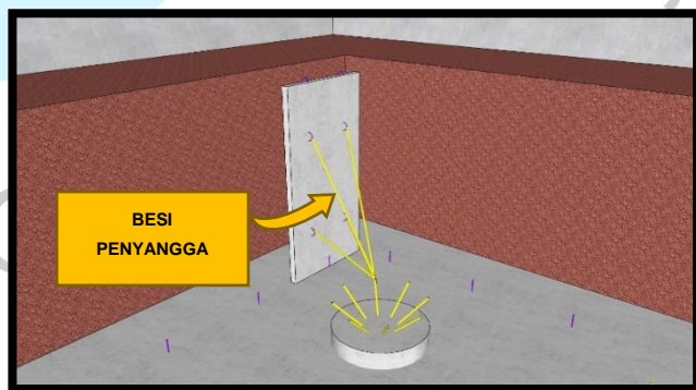
Gambar 3.41 Ilustrasi pemasangan penyangga untuk bekisting precast beton (Dokumen proyek KSO PT PP (Persero) Tbk – PT Arkonin, 2022)
