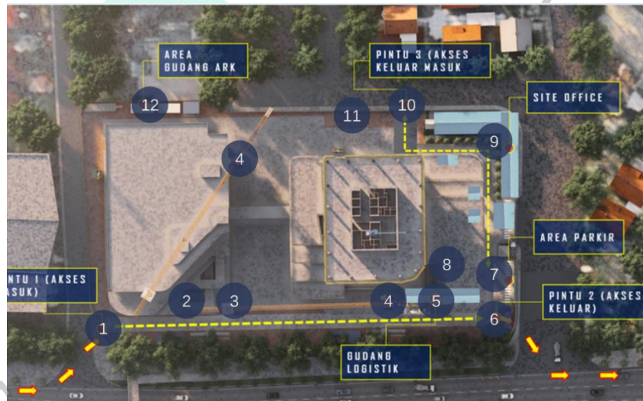
Gambar 3.2 Site Management Gedung IT Bank Mandiri Slipi (Dokumen proyek KSO PT PP (Persero) Tbk – PT Arkonin, 2022)
