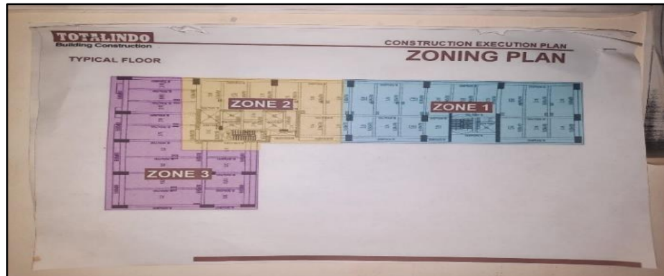
Gambar 3.1 Pembagian Zona Pekerjaan Struktur
