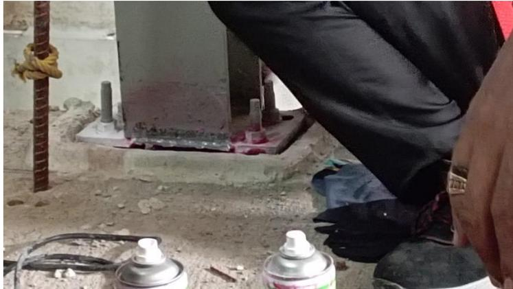
**Gambar 3. 29 Proses Penerapan Penetrant.**
