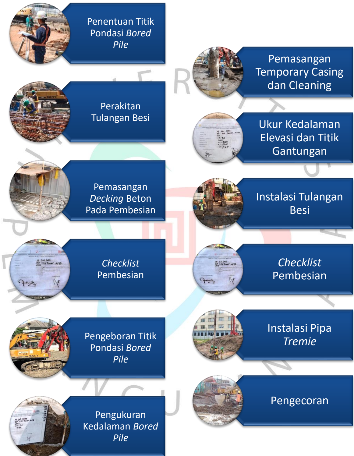
Gambar 3. 9 Alur Pekerjaan Pondasi Bored Pile
