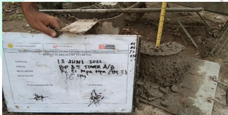
Gambar 3. 29 Pengukuran ketinggian slump
