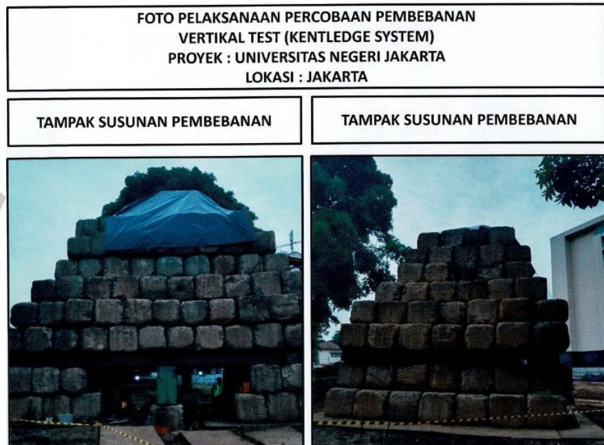
Gambar 3. 36 Tampak Susunan Pembebanan
