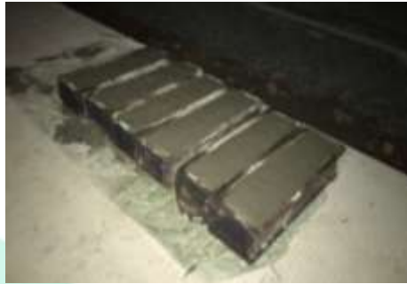
Gambar 3.41 Pengambilan Benda Uji Rigid Pavement
