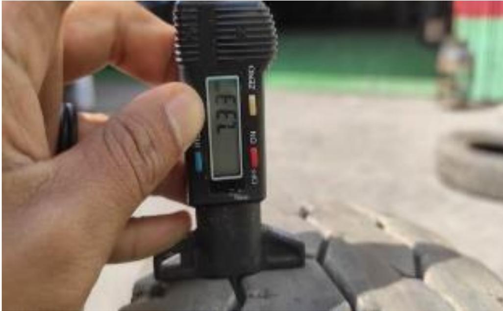
**Gambar 3.8 Pengukuran ban dengan digital *tread depth gauge*
