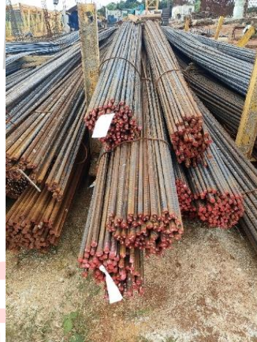
Gambar 3. 9 Besi Tulangan (Sumber: Dokumen Pribadi)
