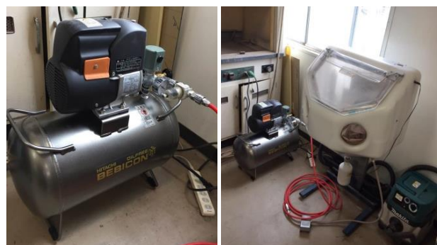
Gambar 1. Alat kompresor dan mini cabinet blasting yang digunakan untuk proses sandblasting
