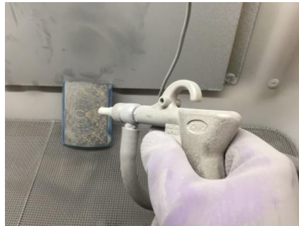
Gambar 4. Proses sandblasting pada permukaan material bambu
