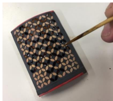
Gambar 5. Contoh proses pewarnaan titik pada permukaan material bambu
