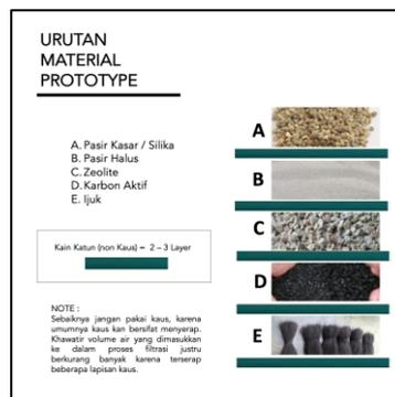
**Gambar 13.** Urutan pemasangan material dalam purwarupa alat filtrasi air sederhana
